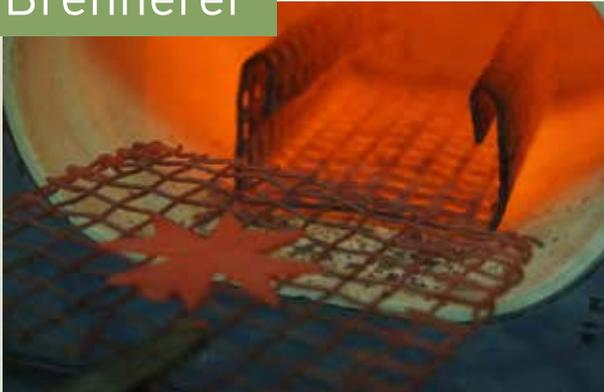
In einem Spezialofen werden die Farben bei 900 Grad C eingebrannt.
